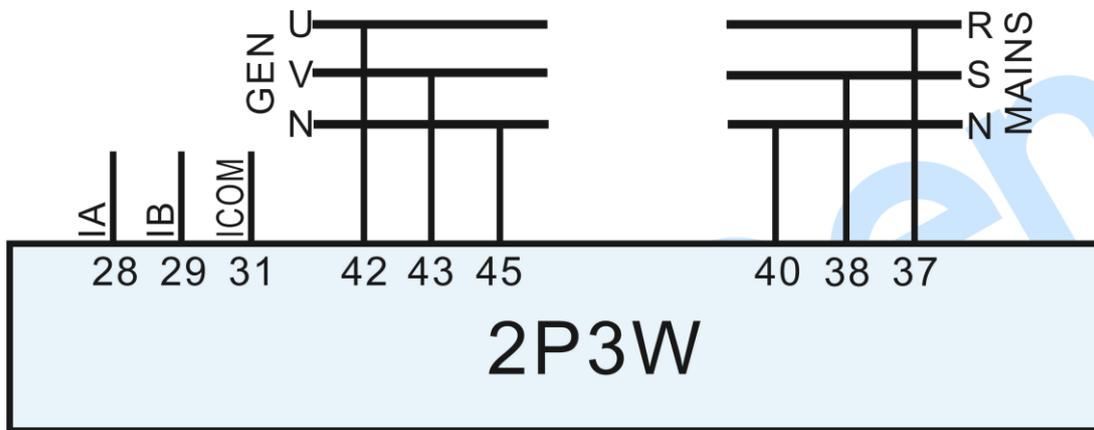
**Fig. 11 – 2 Phase 3 Wire Diagram**
